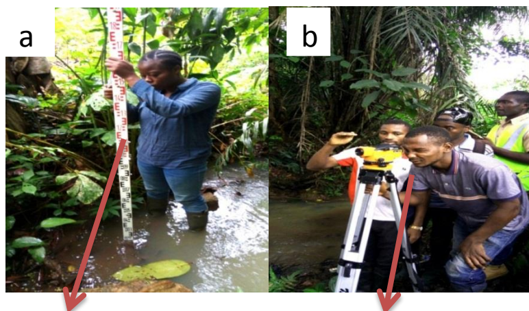
Photo 7: a) Positionnement de la mire b) Lecture de la lunette
