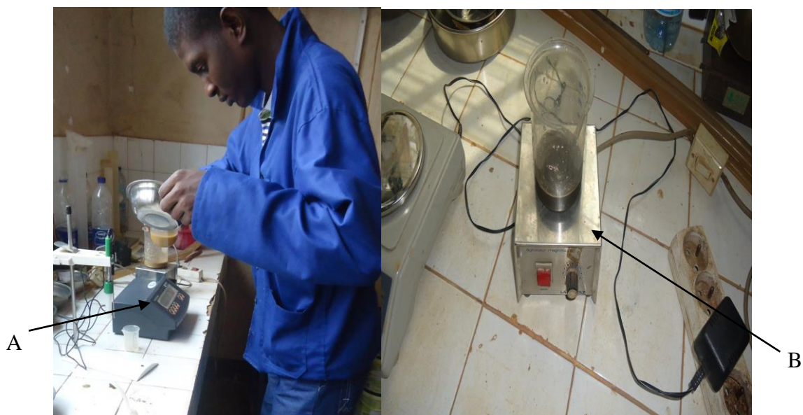
Photo 4 : Mesure du pH (gauche) et agitateur magnétique en activité (droite). A : pH-mètre ; B : Agitateur magnétique.
