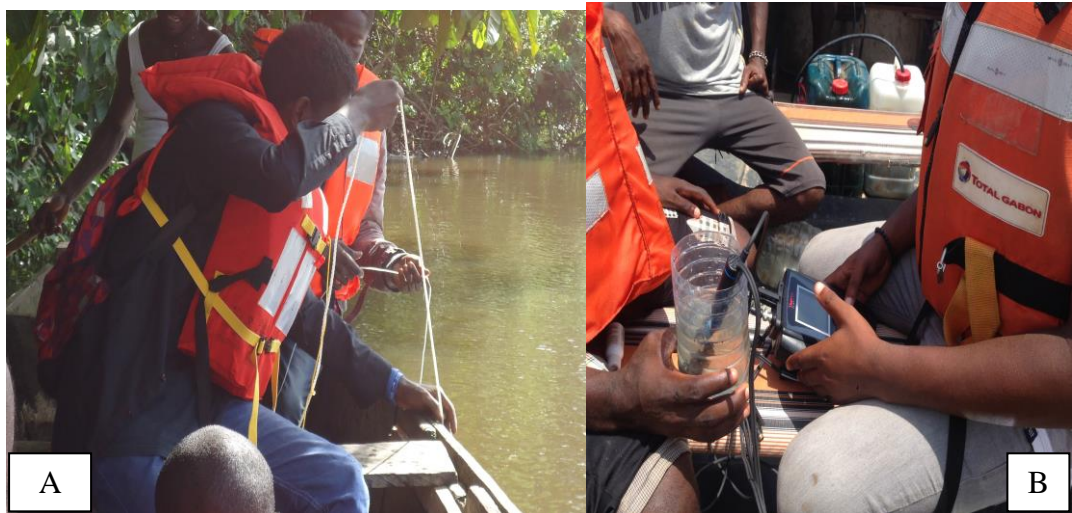
Photo 2 : campagne d'échantillonnage des eaux de fonds sur la Kienke (A) et des eaux de surface sur le Wouri (B)
