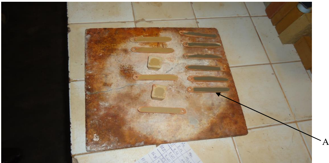
Photo 5 : échantillons séchés et pesés pour mettre au four. A : Lamelles contenant les échantillons.
