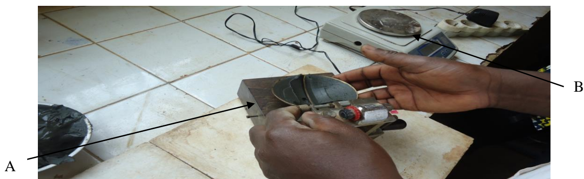
Photo 7 : Appareil de Casagrande chargé. A : Appareil de Casagrande ; B : Balance sensible
