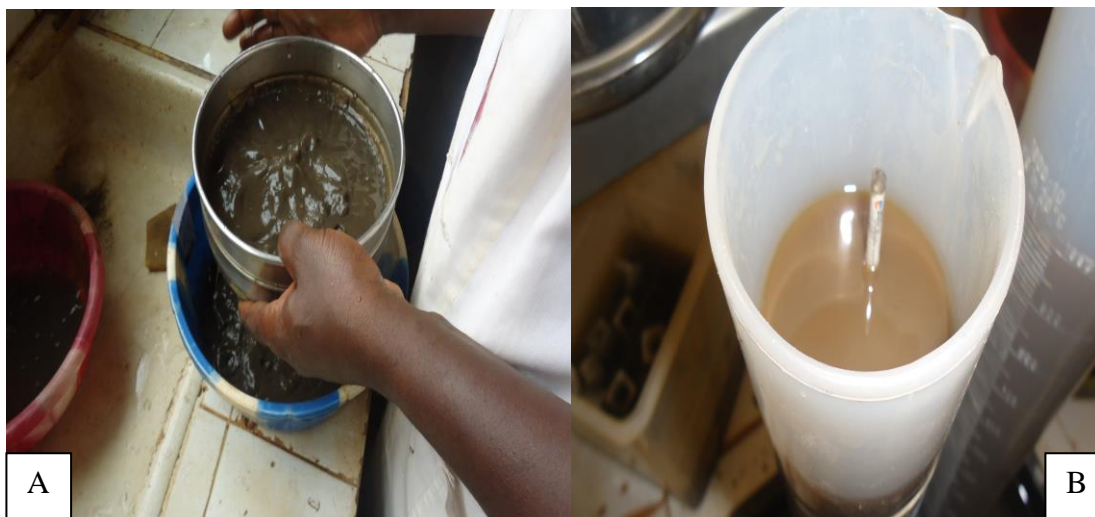
Photo 3 : Tamisage à eau pour séparer à 80 \mu m (A) et lecture du densimètre pour la sédimentométrie (B).
