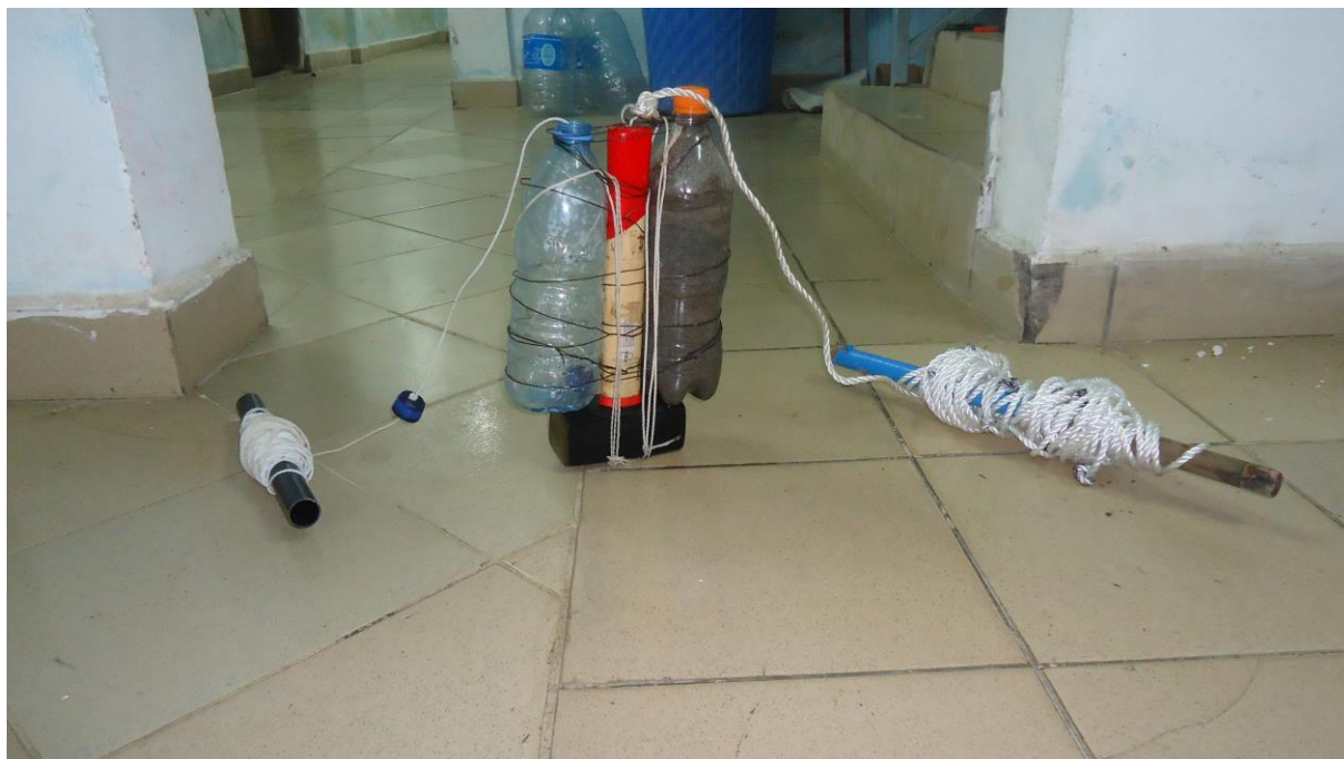
Figure (a) : appareil d'échantillonnage des eaux de fonds.
