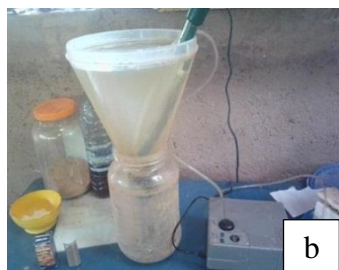
b : dispositif d'éclosion des œufs d'artémia
