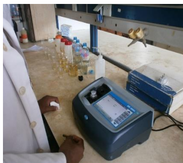
Photo 22 : Mesures à l'aide du spectrophotomètre HACH DR 3900
